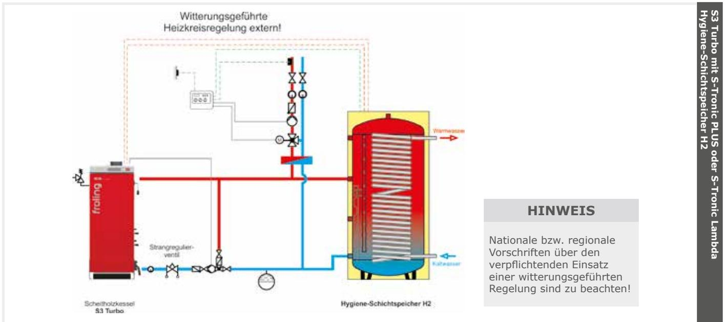
Die **Regelung S-Tronic PLUS und S-Tronic Lambda** ermöglichen ein effizientes Energiemanagement. Bis zu 4 Pufferspeicher, bis zu 8 Warmwasserspeicher und bis zu 18 Heizkreise können in das Wärmemanagement miteinfließen. Ebenso profitieren Sie von Einbindungsmöglichkeiten anderer Energiegewinnungsformen wie etwa Solaranlagen.
